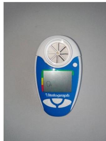
Figure 5 : Spiromètre pour mesurer le volume expiratoire maximal par seconde (VEMS)
