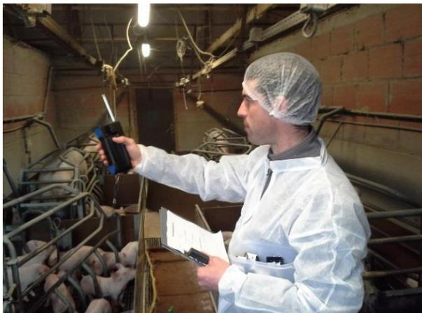
Figure 2 : Mesure des concentrations en ammoniac à l'aide de tubes colorimétriques (Dräger)
